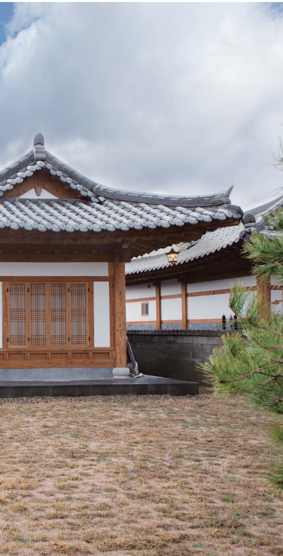
‘ㄱ’자형 단층 오랑 목구조 팔작지붕 아름자리 한옥(左). 빗물이 들어치지 않도록 처마를 길게 뻗고 지붕에서 빗물이 떨어지는 대리석 지대 앞에 흙이 패지 않게 잔돌을 깔았다(右).
