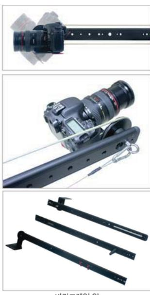
일반적으로 기존 지미집이나 미니집은 더블암 방식으로 설계돼 있어 불업. 불다운시 카메라 수평을 유지하는 기능을 한다. 최근 바라본에서 출시한 틸트집 T3는 이같은 미니집 기능에 카메라 틸트까지 가능케 한 제품이다. 틸트집 T3는 2개의 풀리와 우레탄코팅 스틸와이어를 채택해 수평유지 기능을 구현했다. 또한 2개의 풀리를 회전시켜 틸팅이 가능한 구조가 됐다. 즉 이 제품을 비디오헤드에 장착 시켜 비디오헤드 회전축을 이용해 팬비로 틸팅을 컨트롤할 수 있는 것이다. 전동 팬틸트 헤드가 약간의 딜레이가 발생하는 반면 이 제품은 직관적이고 즉각적으로 반응한다는 것이 특징이다. 구성품으로는 바라크레인 암 3개, 풀리 와이어, 밸런스 와이어, L자 플레이트, 그자 플레이트, 웨이트 연결부 풀, 암 고정 노브 등이 있다.
