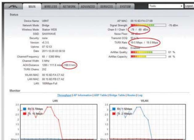
함백산과 울릉도 사이 안테나의 링크상태를 캡처한 화면을 보면 180km 거리-ACK/Distance값은 오차가 있다. 실제거리는 약 200km였다-에서 19.5Mbps의 송수신 속도를 확인할 수 있다. 또한 신호강도(Signal Strength)가 -76dBm으로 영상통화 역시 가능한 수준이다. 19.5Mbps의 전송속도는 실시간 HD영상을 송수신하는데 문제가 없는 수치며 이는 앞에서 언급한 테스트 목적을 달성했다는 것을 의미한다. ■
