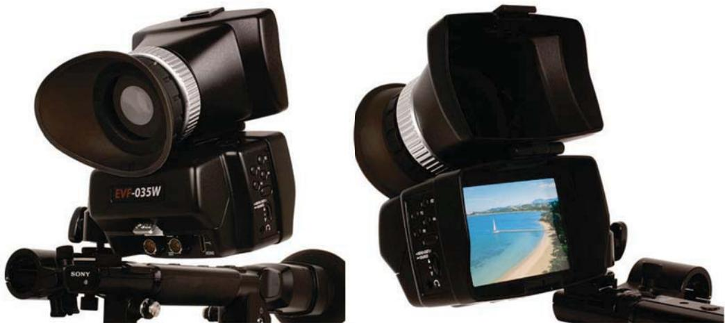
티브이로직이 새롭게 출시한 EVF-035W-3G는 3G HD/SD-SDI, HDMI 등 다양한 영상 인터페이스를 지원한다. 따라서 HDMI 단자를 사용하는 DSLR 카메라뿐 아니라 SDI 출력을 지원하는 카메라에도 대응할 수 있다. 960×640, 960×540 해상도를 지원해 다운 스케일링 화질이 우수하며 견고하고 가벼운 마그네슘 케이스를 채택해 480g 정도로 가볍고 방열성이 좋다. 또 제품측면에 있는 4개의 기능키와 컨트롤 노브를 돌려 원하는 기능을 간편하게 실행할 수 있다. 이밖에 별도의 외장 컨버터없이 HDMI-SDI 변환출력, SDI-SDI/HDMI-HDMI 액티브 루프 쓰루아웃 등을 지원한다. 기존 렌즈캡 방식의 렌즈커버가 아닌 셔터방식의 커버를 채택해 간단한 조작만으로 직사광선으로부터 LCD를 보호할 수 있다.
