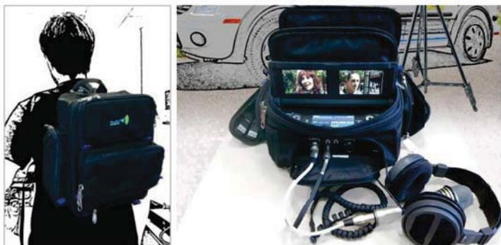
Ikusnet은 TVU Pack, LIVE U 등과 유사한 실시간 중계 장비로 이를 이용해 언제 어디서나 실시간 중계를 할 수 있다. 이 제품은 1개의 영상만 전송가능한 기존 장비들과 달리 2대의 카메라신호를 입력받을 수 있고 양방향 라이브 비디오 및 오디오/토크백 스트림 기능이 탑재돼 있다. 또 IP링크를 통해 HD/SD MPEG-4 AVC/H.264 등의 포맷으로 생방송이 가능하며 실시간 콘텐츠 저장 및 FTP 업로드가 가능하다. Ikusnet은 최대 8링크를 지원 하며 3G/4G/Dual-Ethernet을 채택했다. Ikusnet과 함께 사용하는 Ikusnet ST는 Ikusnet에서 보낸 화면을 3G/4G 망으로 전송받아 출력하는 마운팅 유닛이다.
