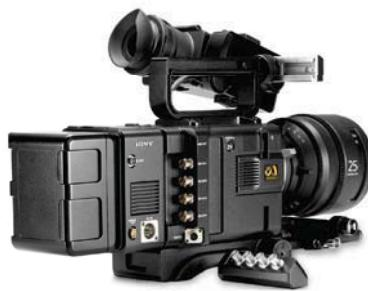
소니가 새롭게 개발한 XAVC 코덱을 지원한다. 이외에 MPEG-4 SSIP, MPEG HD422 등 총 4종류의 영상포맷에 대응한다. 따라서 제작예산 및 워크플로 등 용도에 맞는 포맷선택이 가능하다. 다만 16비트 리니어 RAW는 소니의 새로운 RAW 리코더 AXS-R5를 통해 AXS 메모리카드에 기록되며 다른 포맷은 카메라 본체에 삽입된 SxS 메모리카드에 기록가능하다.
